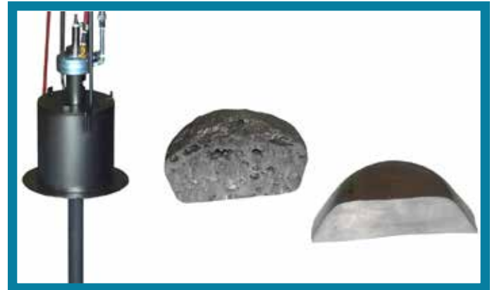
Desgasificador rotatorio y muestras de metal limpio vs. metal malo
